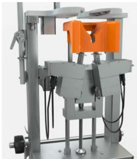
Bis zu fünf synchron arbeitende Impfnadeln reduzieren den Impfstress für die Tiere
